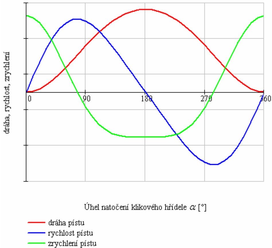
Graf 4 Průběh dráhy, rychlosti a zrychlení pístu během jedné otáčky klikového hřídele
