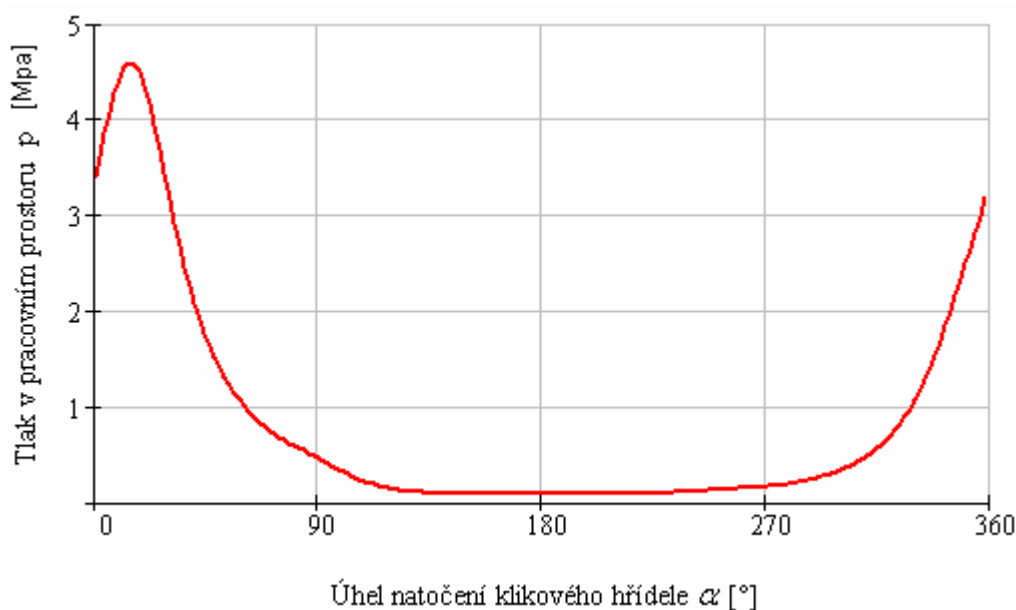
Graf 5 p- \alpha diagram pracovního oběhu motoru
