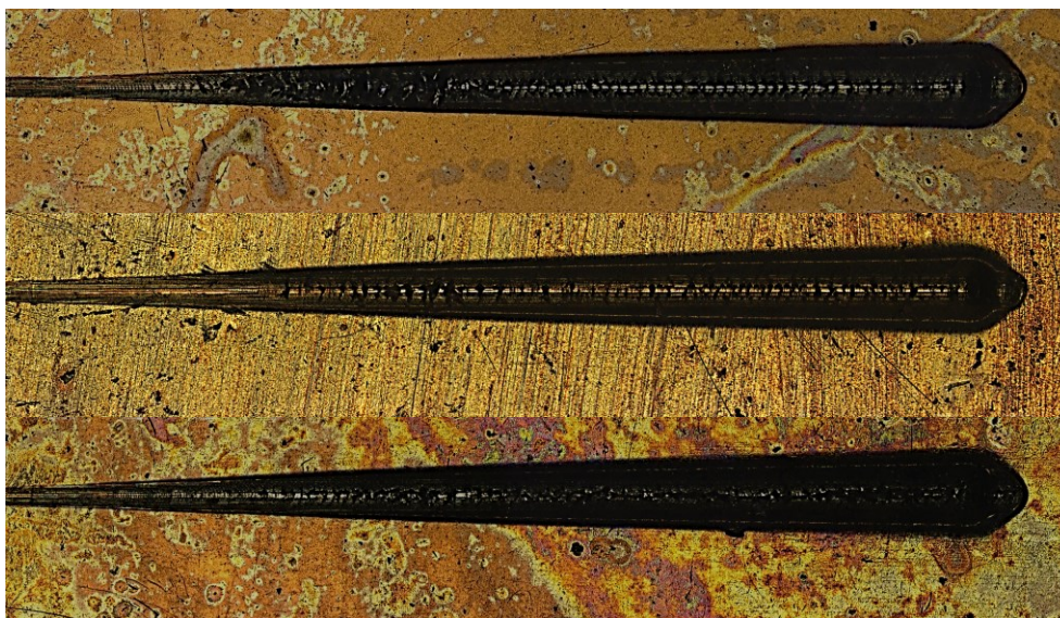
Obrázek 7.4: Zobrazení průběhu vrypu LEX, vztaheno k Obrázku 7.5 (od vrchního: IPA, NaOH, plazma)
