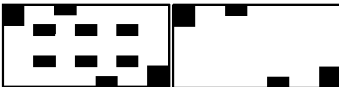
Obrázek 8.2: Izolační vrstvy pro realizaci vícevrstvé struktury (zleva: izolační vrstva mezi první a druhou vrstvou, izolační vrstva mezi druhou a třetí vrstvou)
