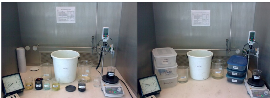
Obrázek 1.9: Ukázka možného uspořádání pracoviště pro předúpravu a pokovení PET [5]
