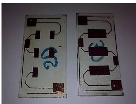
Obrázek 8.3: Zobrazení výsledné struktury (vlevo: první vodivá vrstva, vpravo: kompletní vodivá struktura)
