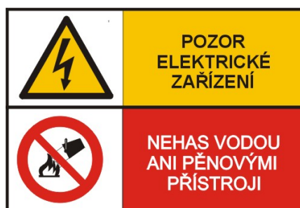
Obrázek 92 - Výstražný a zákazový štítek na rozvodných skříních
