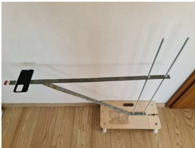
Obr. 5.1: Vozík ktorým boli snímané povrchy a materiály. Obsahuje kryt do ktorého sa uchytí telefón a kameruje sa podlaha. Aktuálna verzia umožňuje zmeniť výšku snímania.
