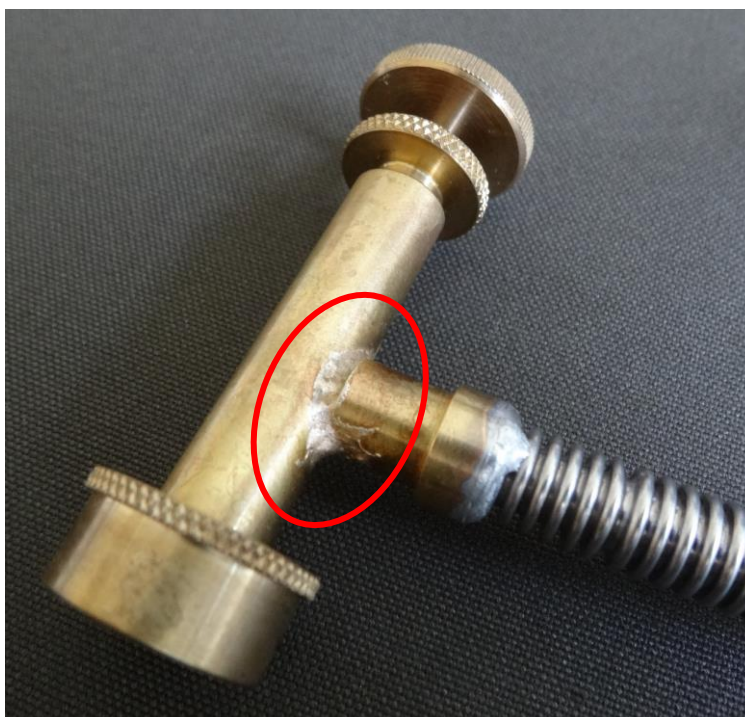
Obr. 26 Čerpací ventil – tvrdé pájení plamenem
