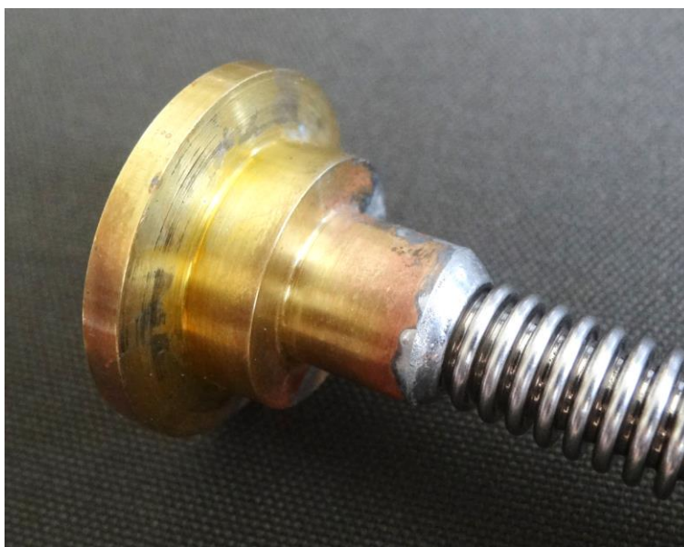
Obr. 27 Spojení koncovky ventilu s vlnovcem měkkým pájením
