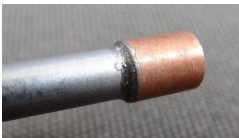
Obr. 20 Vakuové tvrdé pájení – spojení kapiláry s měděnou koncovkou
