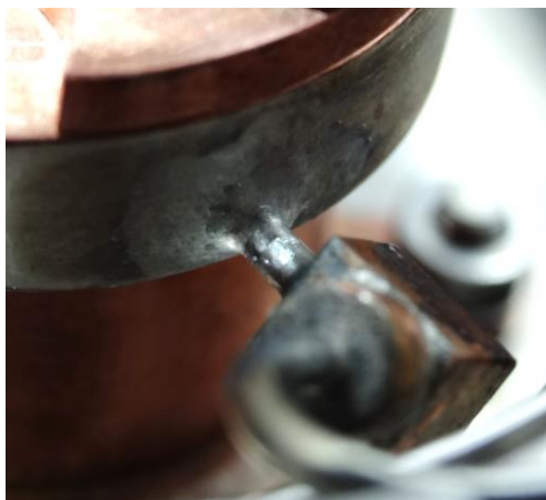
Obr. 21 Spojení tepelného výměníku s kapilárami měkkým pájením
