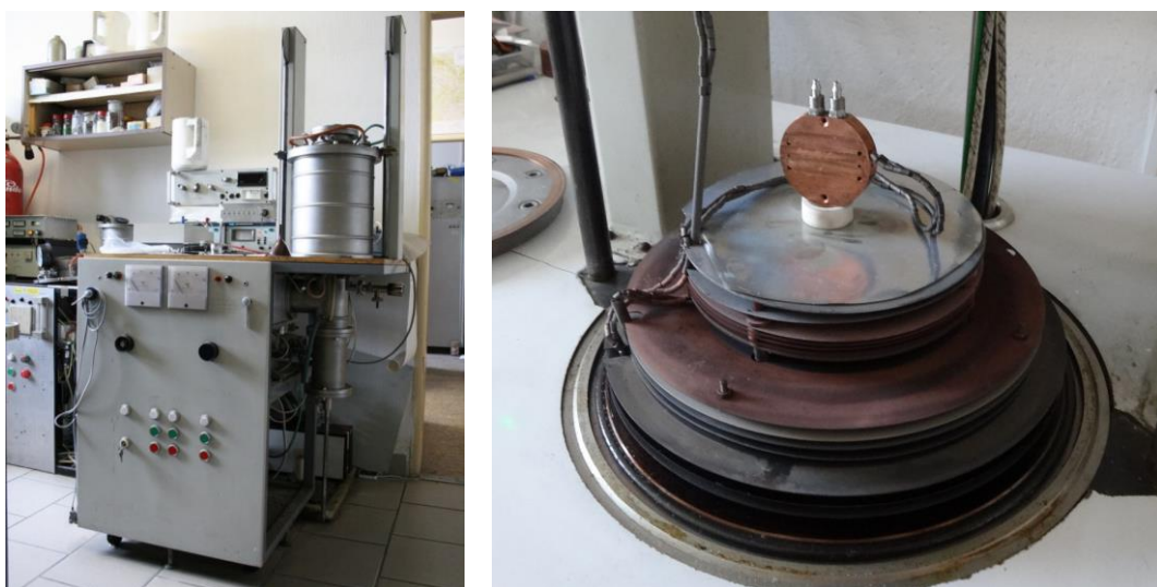
Obr. 12 Vlevo: Laboratorní vakuová pec [28] Vpravo: Pohled do pracovní komory pece
