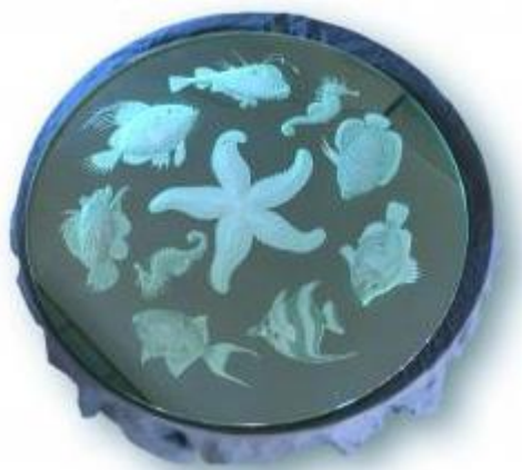
Obr. 2.6 Gravírování do skla technologií AWJ.[27]
