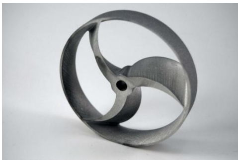
Obr. 3.2 Díl vyrobený technologií Dynamic Waterjet XD.[30]
