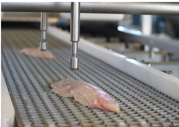
Obr. 2.1 Řezání ryb technologií WJM.[20]
