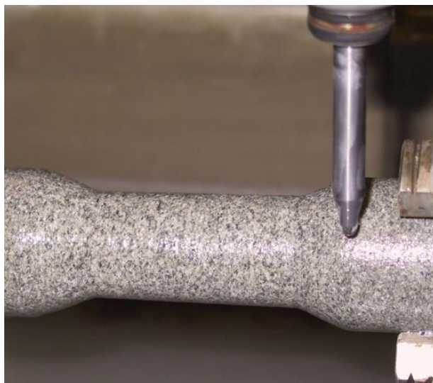
Obr. 2.4 Ukázka soustružení pískovce AWJ.[23]
