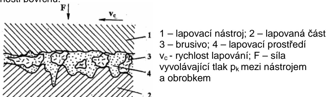
Obr. 5.1 Schéma řezného procesu při lapování [4]
