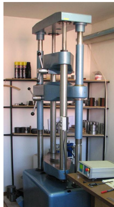
Obr. 45 Hydraulický zkušební stroj ZD40 /400kN/
