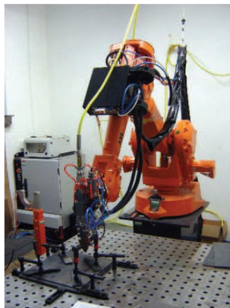
Obr. 44 Průmyslový robot IRB 2400 - 10
