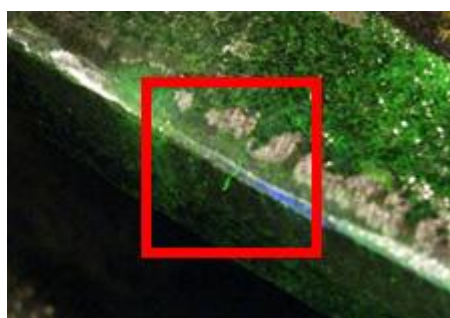
Obr. 23 Magnetická prášková zkouška [28]
