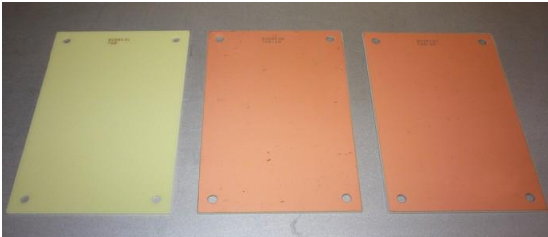
Obr. 36: Desky pro kalibraci simulací (zleva: FR4 bez mědi, FR4 s mědí 18 \mu\text{m} a s 35 \mu\text{m} ).
