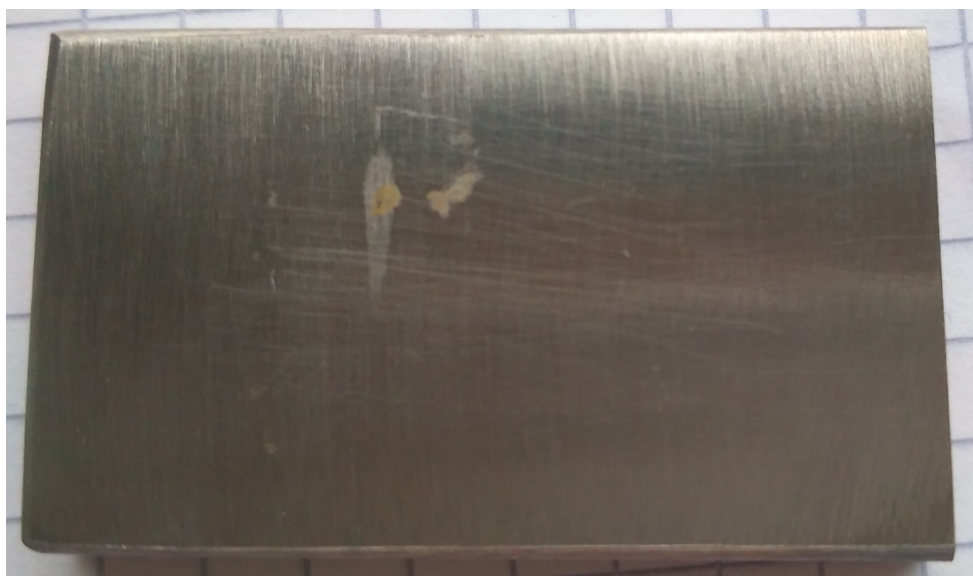
Obr. 41 Korózia na vzorke lopatky.
