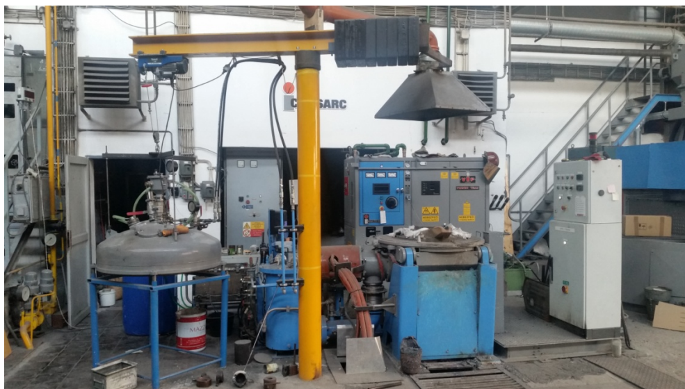
Obr. 19 Vákuová indukčná pec Consarc.
