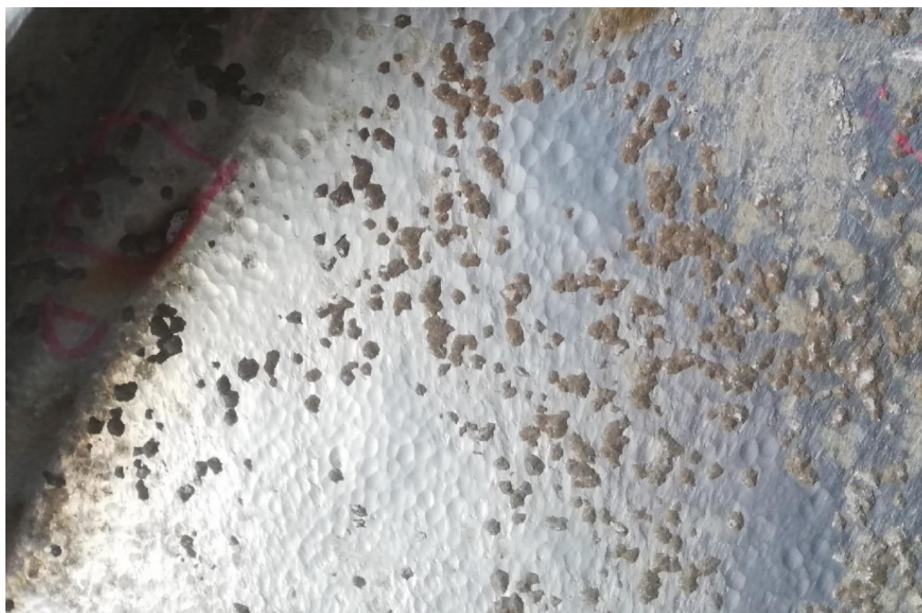
Obr. 17 Nárasty na stene lopatky spôsobené jamkovou koróziou [40].
