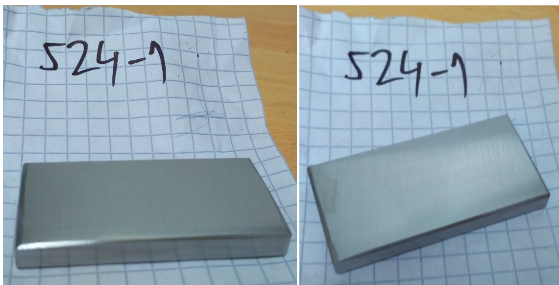
Obr. 25 Vyčistená vzorka na koróznú skúšku (obe hlavné plochy vzorky 524-1).
