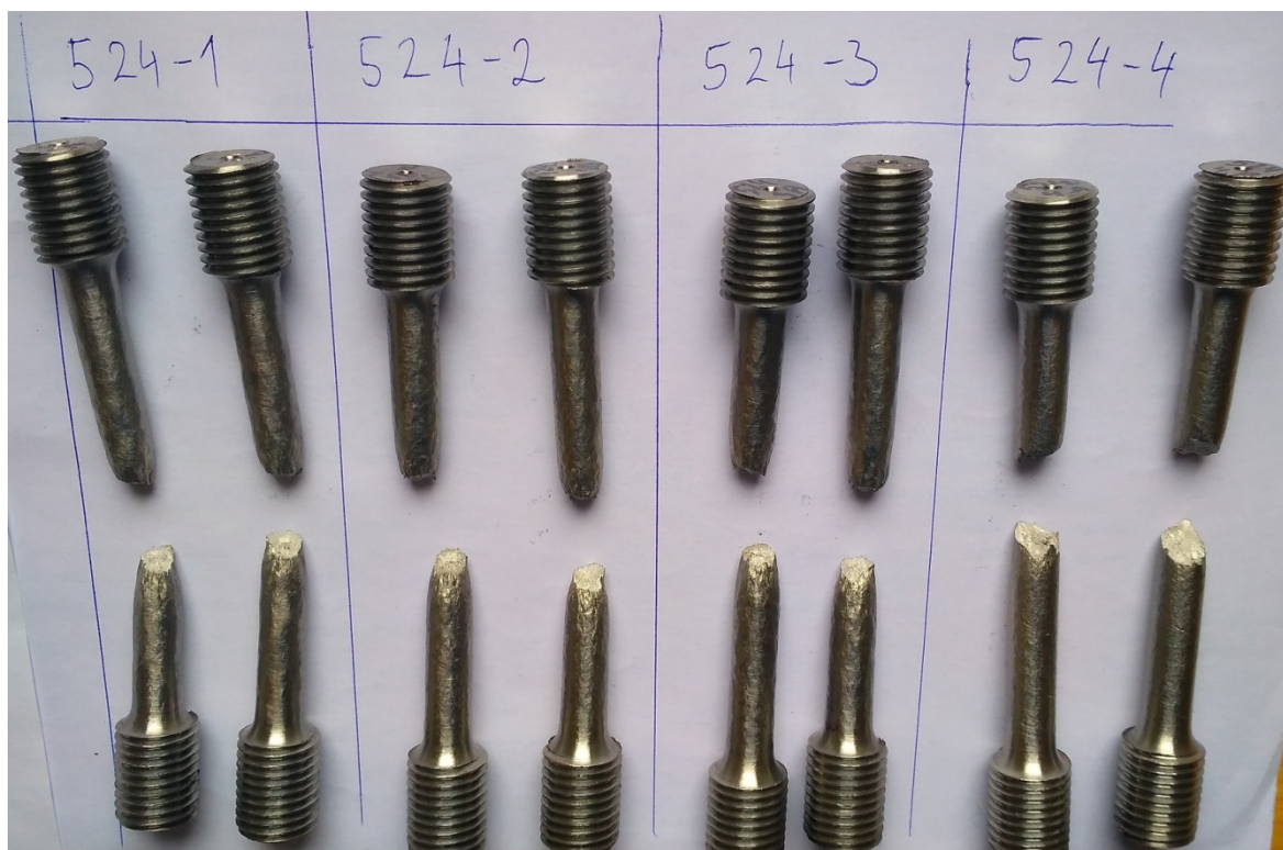
Obr. 27 Vzorky po skúške ťahom.
