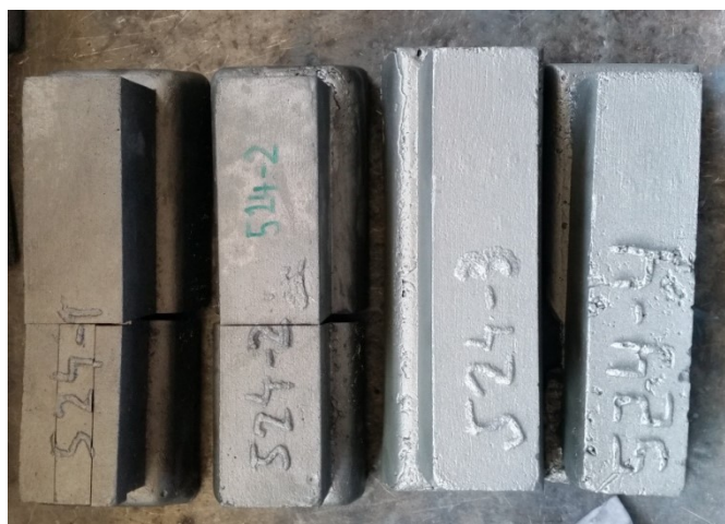
Obr. 22 Rezanie vzoriek na mechanické skúšky
