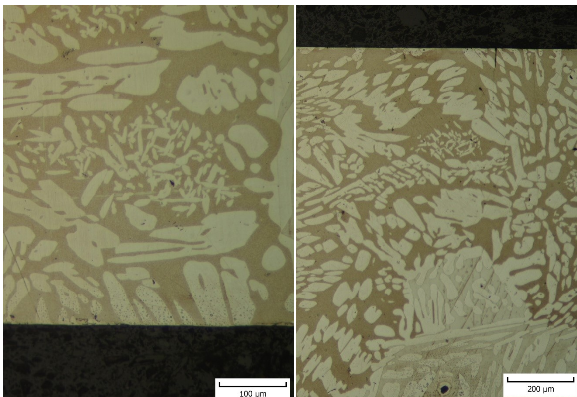
Obr. 40 Mikroštruktúra vzorky z lopatky miešadla.
