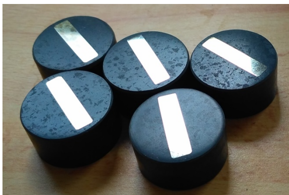
Obr. 34 Vzorok na metalografické pozorovanie
