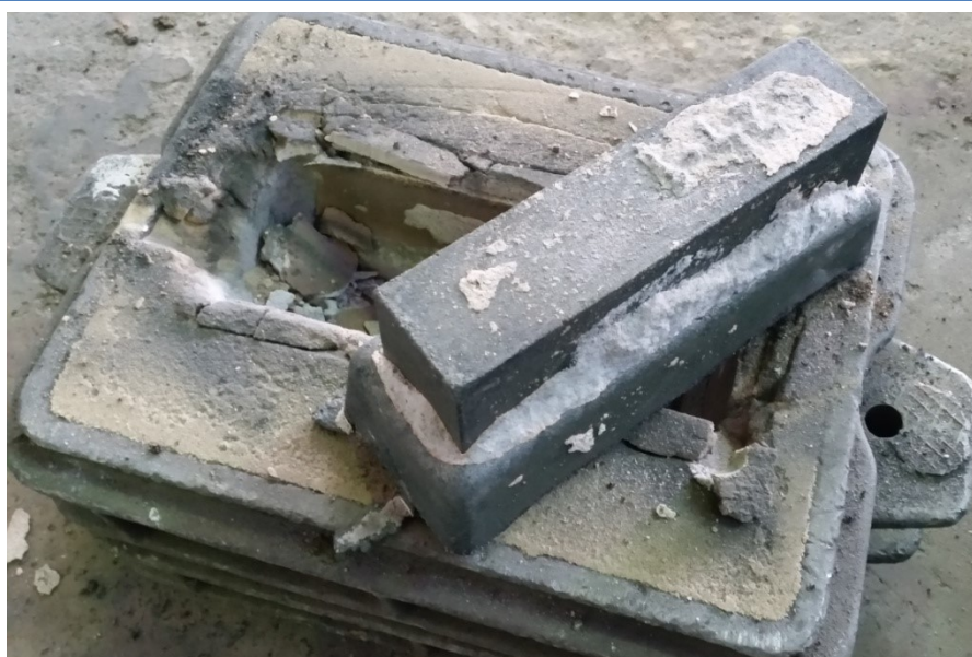
Obr. 20 Odliaty Y-blok s jeho formou.
