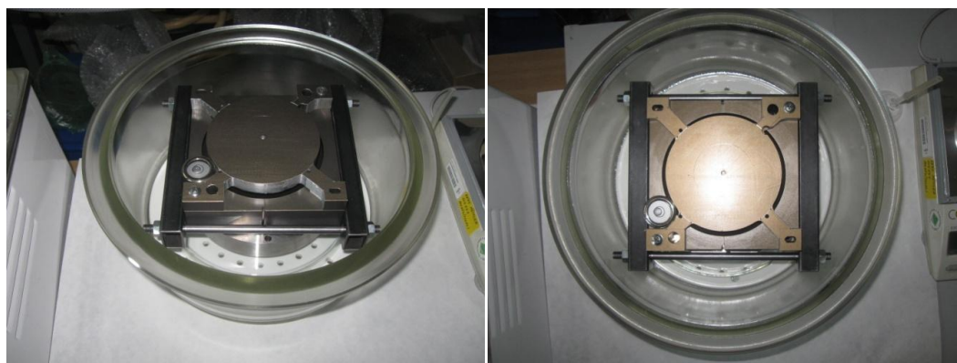
Obr. 42: Uložení formy do exsikátoru
