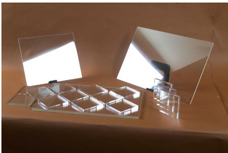
Obr. 10: Komerční produkty z materiálu ALON TM [21]
