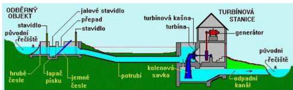
Obrázek 6: Schéma provedení středotlaké vodní elektrárny
