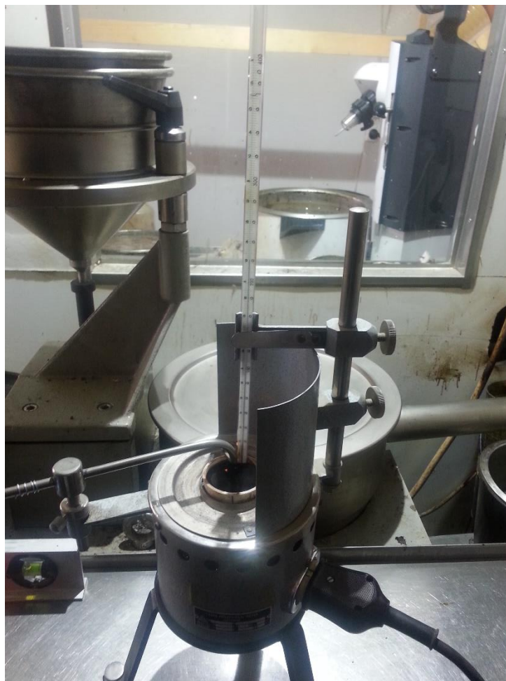
Obrázek 8: Pohyb zkušební plamen nad vzorkem
