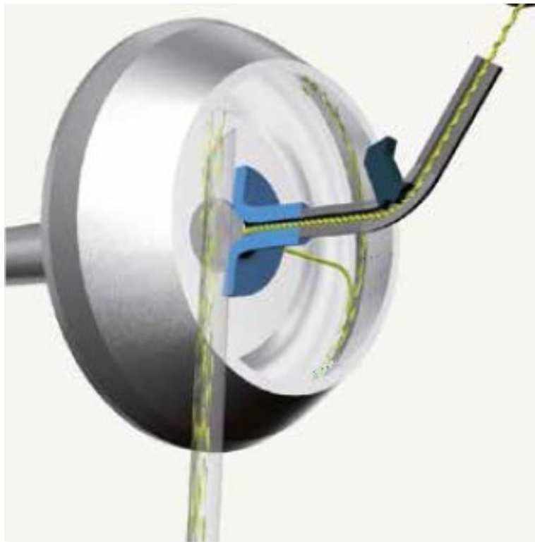
Obr. 4.3 Princip zákrutu v rotoru [9]
