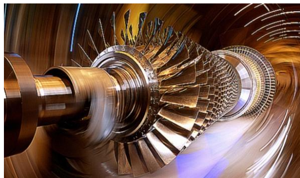
Obr.12 lopatky turbíny ze superslitiny [8]
