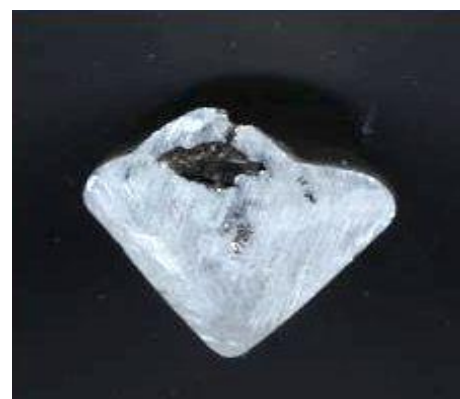
Obr.43 příklad bubliny v odlitku [23]
