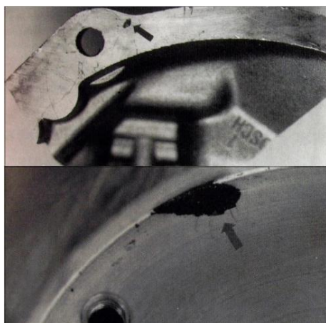
Obr.42 korundový vměstek na povrchu součásti [22]
