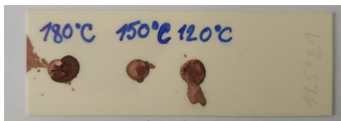
Obrázok 22 – Vrstva medi na Pd prekurzore na každej teplote
