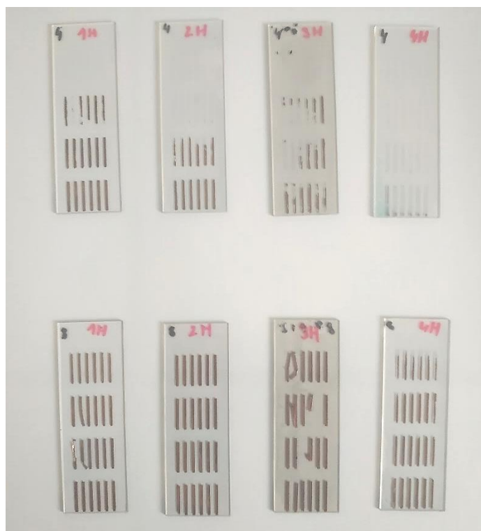
Obrázok 44 – Výsledný natlačený Pd prekursor s narastenými vrstvami Cu, Pd prekursor: vrchná časť vrstvy od 1 do 4, spodná časť vrstvy od 5 do 8
