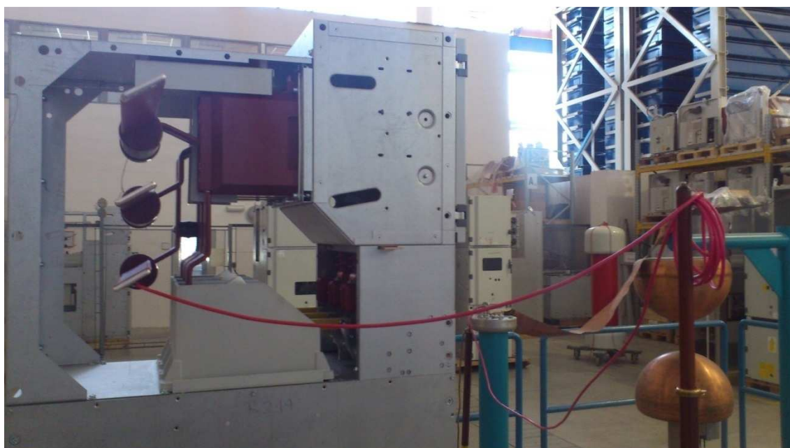
Obrázek 25: Připojení na jednu fázi přípojnic rozvaděče při zkušebním měření
