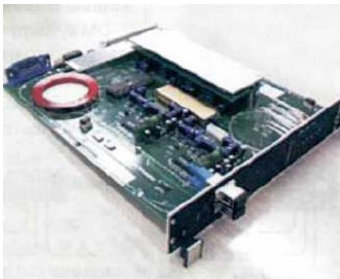
Obr. 15.4: Kompenzátor PMD prvního řádu od Furukawa Electric Co., Ltd., s optickým PC, DOP monitorováním (stupně polarizace), s CPU, GPIB, RS232C [20]
