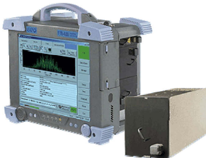
Obr. 13.4: Univerzální měřicí systém FTB-400 s PMD analyzátozem FTB-5500B
