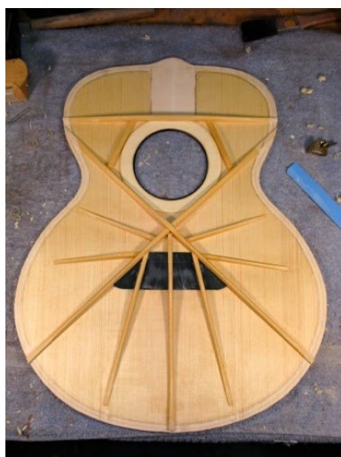
Obr. 2.2: Ukázka žebrování typu X (8)
