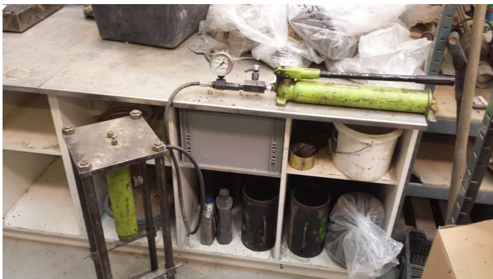
Obrázok 17 : Ručná hydraulická pumpa s hydraulickým lisom v ocelevej konštrukcii
