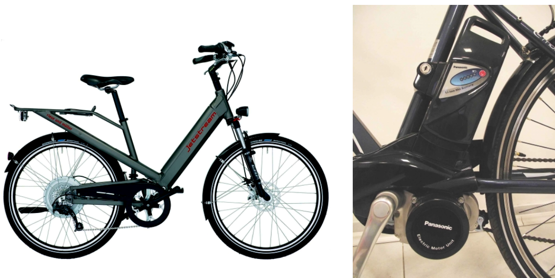
Obr. 2 Kolo s elektromotorem umístěným v náboji zadního kola značky Jetstream (vlevo), Kolo s elektromotorem napojeným přímo na řetěz od společnosti HB Bikes (vpravo) [4]
