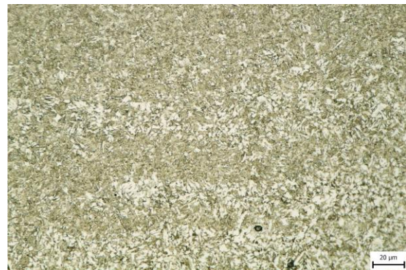
Obr. 62 Mikrostruktura z částečné překrystalizace vzorku 10.
