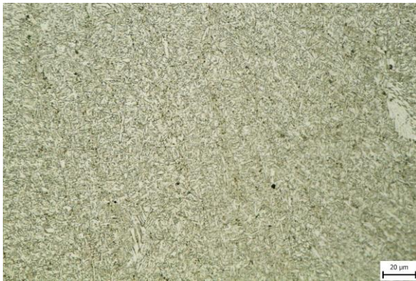
Obr. 59 Mikrostruktura svarového kovu vzorku 10.
