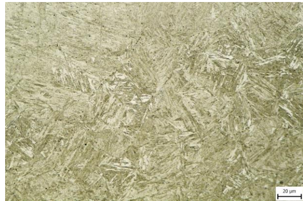
Obr. 60 Mikrostruktura ve vysoce přehřáté oblasti vzorku 10.
