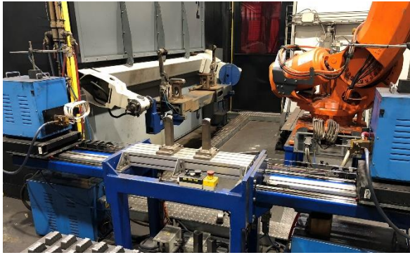
Obr. 17 Indukční přehřev příčnicku a robotická sestava pro usazení céček na příčník.
