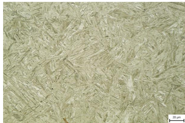
Obr. 56 Mikrostruktura ve vysoce přehřáté oblasti vzorku 9
