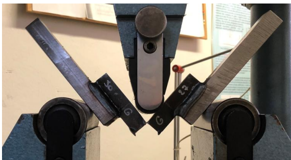
Obr. 88 Svařenec jen pár okamžiků po úplném rozlomení.
