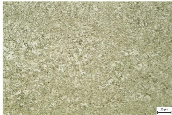
Obr. 66 Mikrostruktura z částečné překrystalizace vzorku 11.
