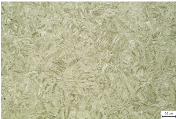
Obr. 57 Mikrostruktura z pásma normalizace vzorku 9.
