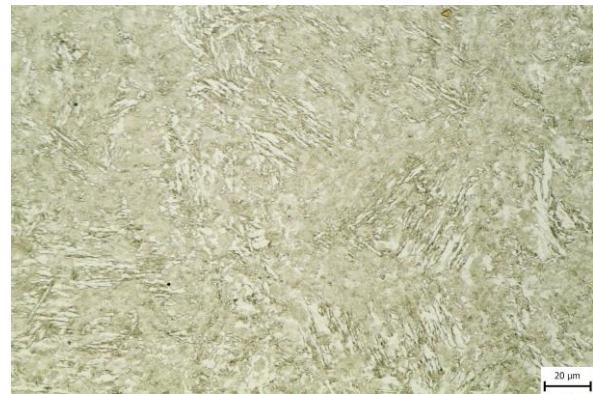
Obr. 58 Mikrostruktura z částečné překrystalizace vzorku 9.
