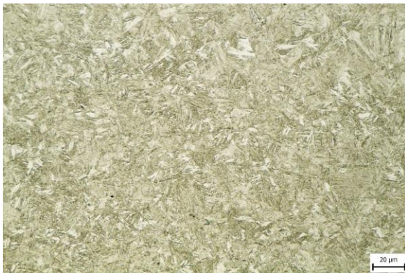
Obr. 65 Mikrostruktura z pásma normalizace vzorku 11.
