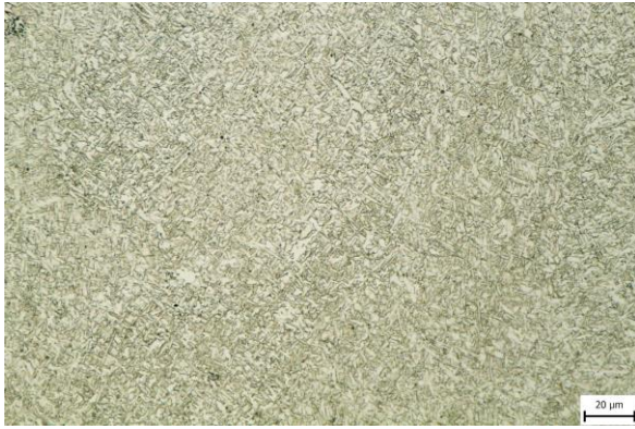
Obr. 63 Mikrostruktura svarového kovu vzorku 11.
