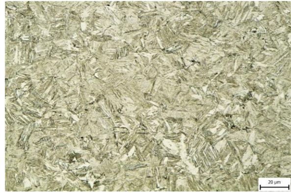
Obr. 68 Mikrostruktura základního materiálu vzorku 4 (oceli 30MnB5).
