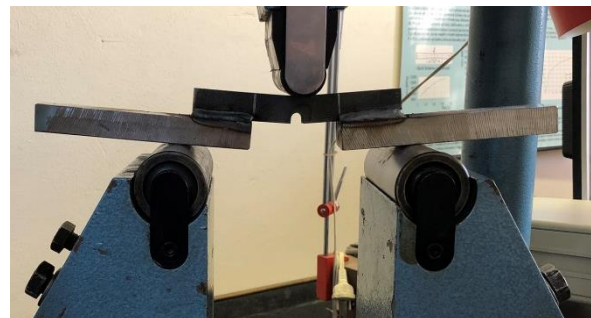
Obr. 84 Vzorek základního materiálu těsně před rozlomením.
