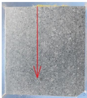
Obr. 71 Schematické znázornění linie vtisků na vzorku 2.
