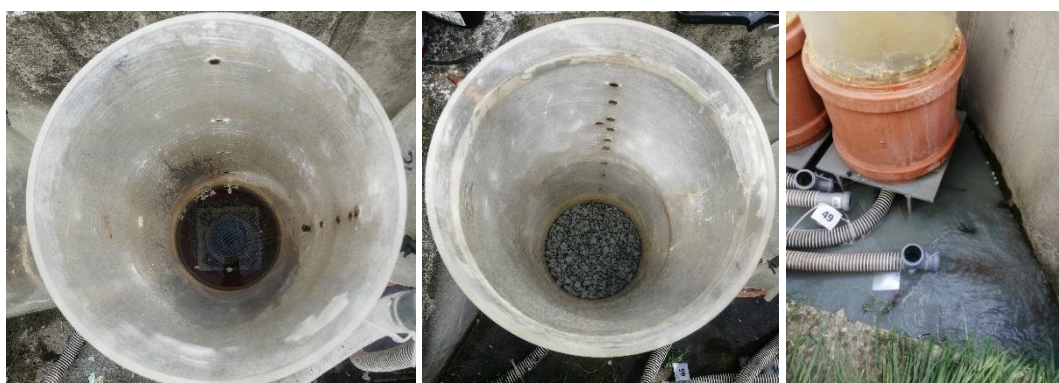
Obr. 25 Drenážní vrstva testovacích těles a její úprava praním
