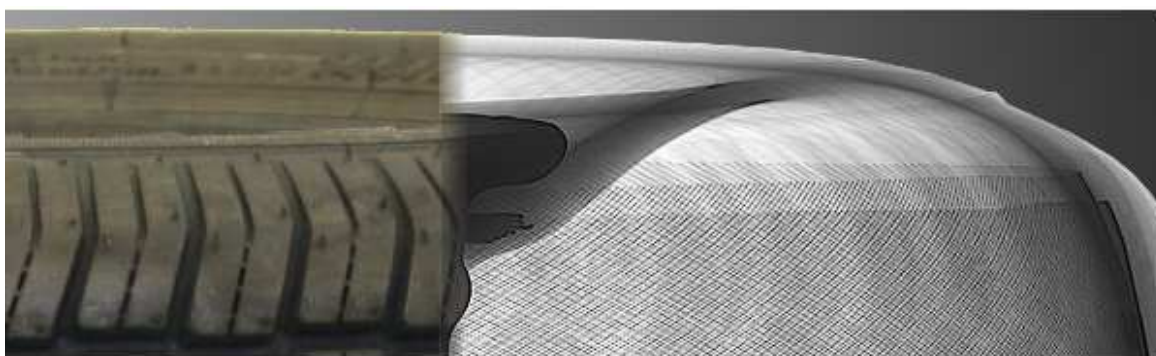
Obr. 1.1 – rentgenový snímek pneumatiky [1]
