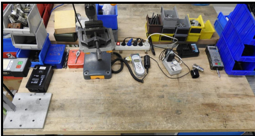
Obr. 3.6 Umístění vrtačky spolu s měřičem krouticího momentu a měřiči sil
