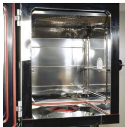
(detail testovacího prostoru komory)
