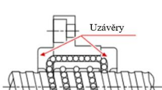
Obr. 4.11 Recirkulace převáděcím kanálem – schéma (vlevo) a 3D model [20]
