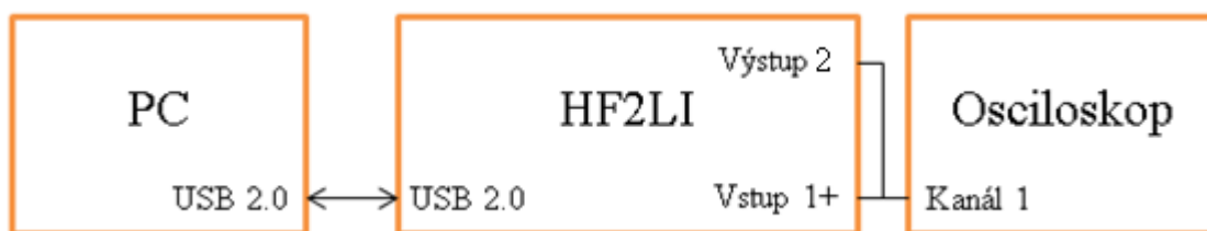
Obr. č. 7.1: Bloková schéma zapojenia pre experiment
