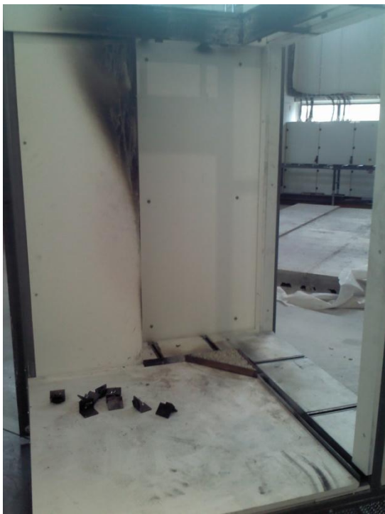
Obr. 25 Vozík se stojanem (SBI test)
