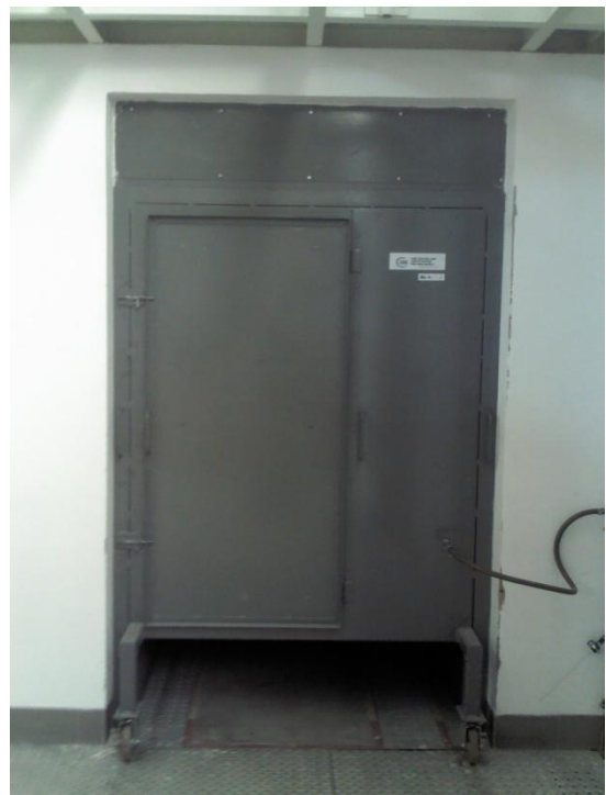
Obr. 26 Zkušební komora (SBI test)
