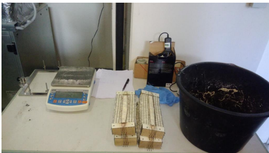
Obr. 20 Příprava vzorků pro zkoušku malého plamene
