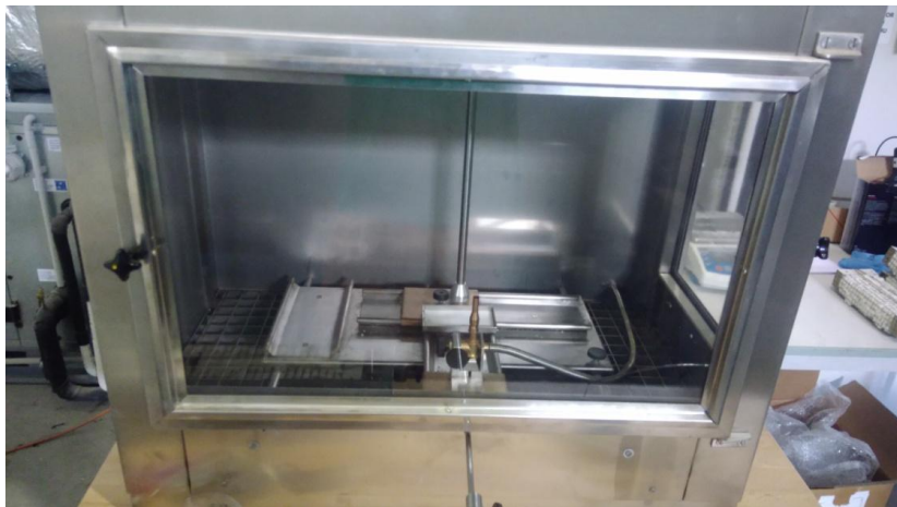
Obr. 23 Zkušební komora pro zkoušku zápalnosti
