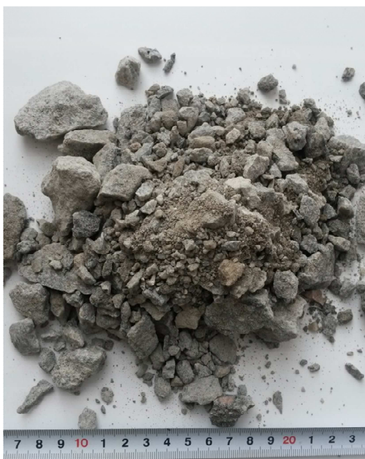
Obrázek 14 Betonový recyklát D1 0/22,4 – čelistový drtič [0]
