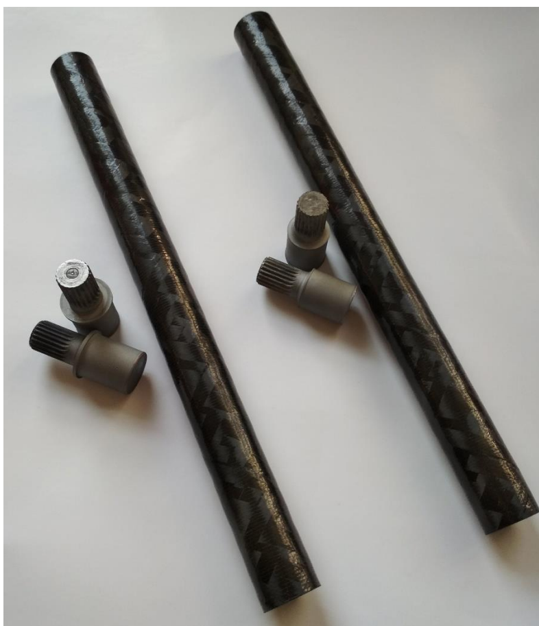
Obr. 34 - Kalené ocelové vložky a kompozitní trubka před slepením vzorku
