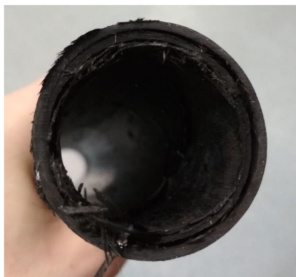
Obr. 37 - Porucha trubky u vzorku C
