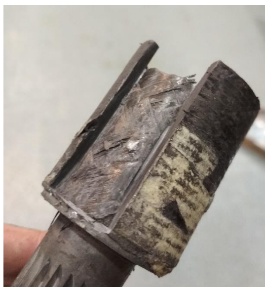
Obr. 36 - Řez vzorek C lepidlo Loctite
