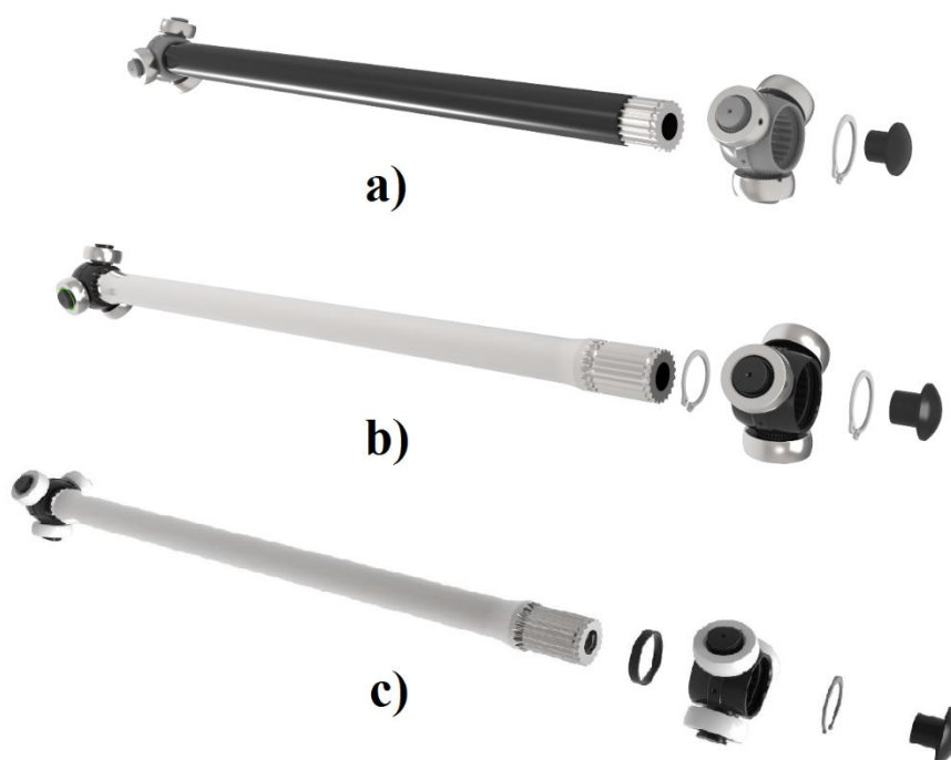
Obr. 5 - Tři varianty axiálního zajištění tříramenného kloubu na hřídeli
