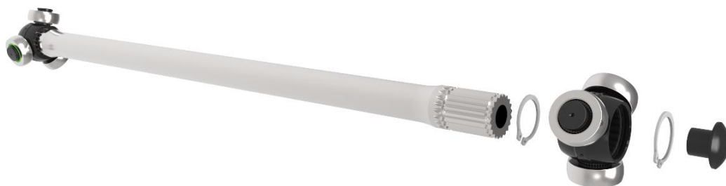
Obr. 3 - Model příčné hnací hřídele s třiramennými klouby z vozu Dragon 6
