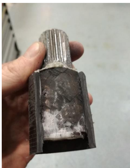
Obr. 35 - Vzorek A - delaminace
