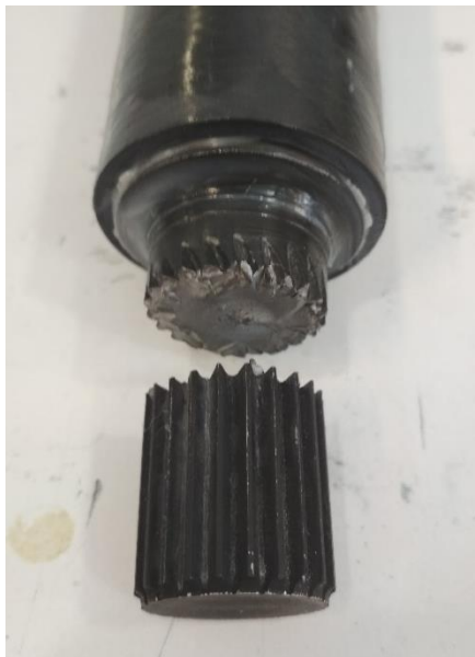
Obr. 39 - Porucha vložky na vzorku C
