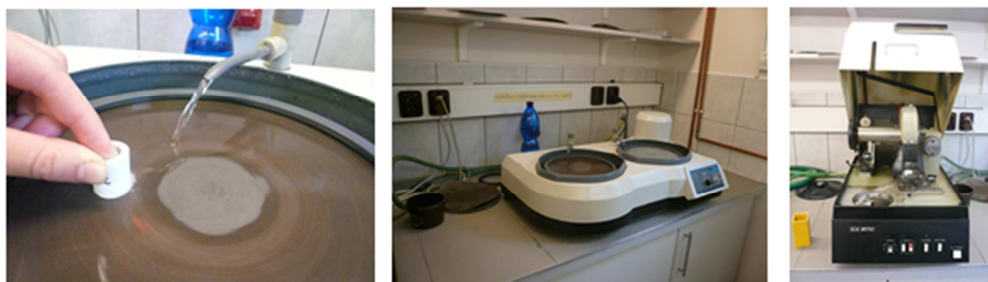
Obrázek 12. a) leštění vzorku b) broušení vzorku c) řezání vzorku
