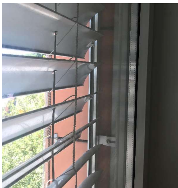
Obrázek 61 Fotografie z měření – sklon lamel 30°
