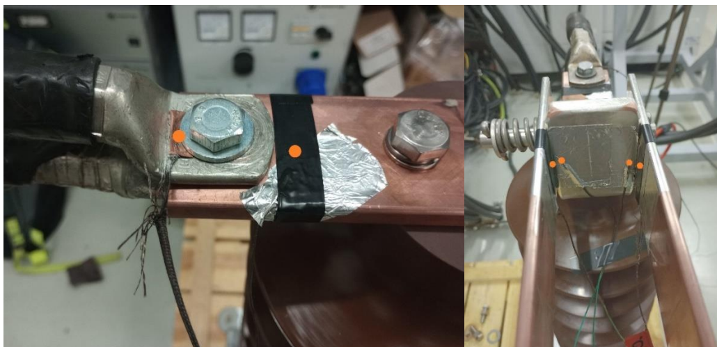
Obrázek 8.9 Fotografie umístění a označení teplotních sond na vlevo šroubové spojení, vpravo u hlavního kontaktu
