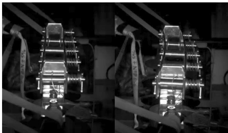
Obrázek 8.17 Snímky pořízené rychlokamerou - vlevo před působením elektrodynamických sil, vpravo účinek elektrodynamických sil způsobených U-smyčkou celého zkušného obvodu
