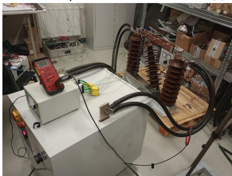
Obrázek 8.10 Fotografie kompletního pracoviště při zkoušce trvalým proudem.
