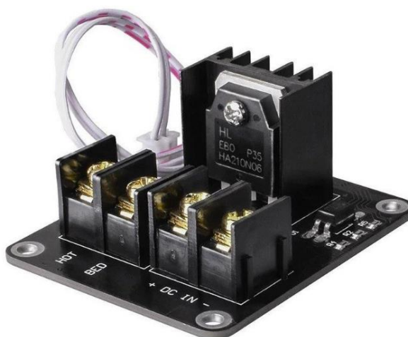
Obrázek 4.6 PWM MOSFET modul HA210N06 25 A [42]
