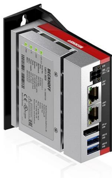
Obrázek 3.6 Průmyslový počítač C6015-0010 [18]
