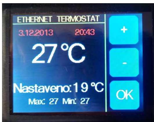
Obr. 2.1: Zobrazení nastavené a změřené teploty na TFT LCD dotykovém displeji
