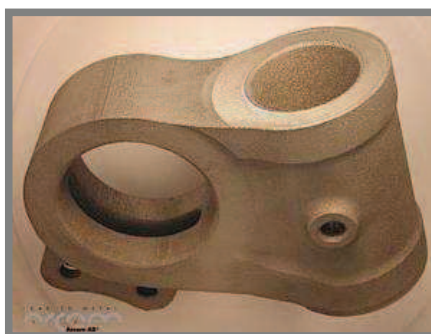
Obr. 41 Převodová skříň v přístávacím ústrojí vyrobená EBM [20]
