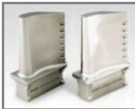
Obr. 19 Turbinová lopatka vyrobená DMLS [13]
