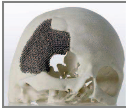
Obr. 45 Mřížový lebeční plát vyrobený EBM z Ti6Al4V ELI [20]
