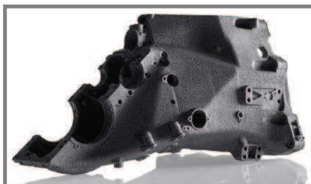
Obr. 42 Automobilová převodová skříň vyrobená EBM z Ti6Al4V [20]
