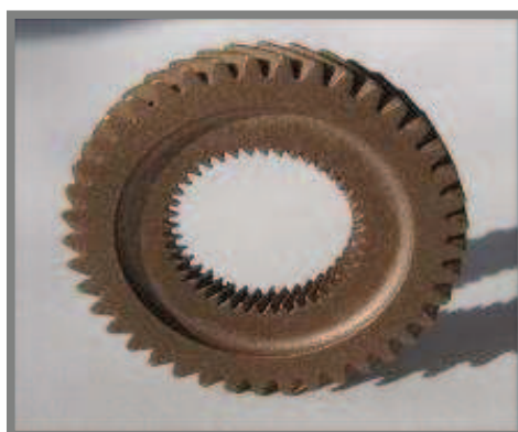
Obr. 21 Prototyp ozubeného kola vyrobený DMLS [12]
