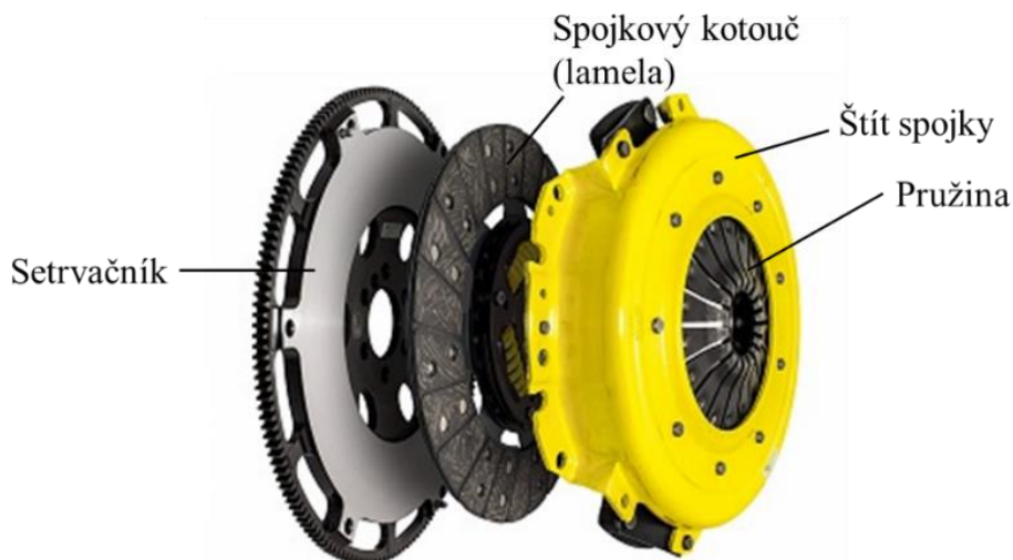
Obrázek 1 Třecí suchá spojka [4]
