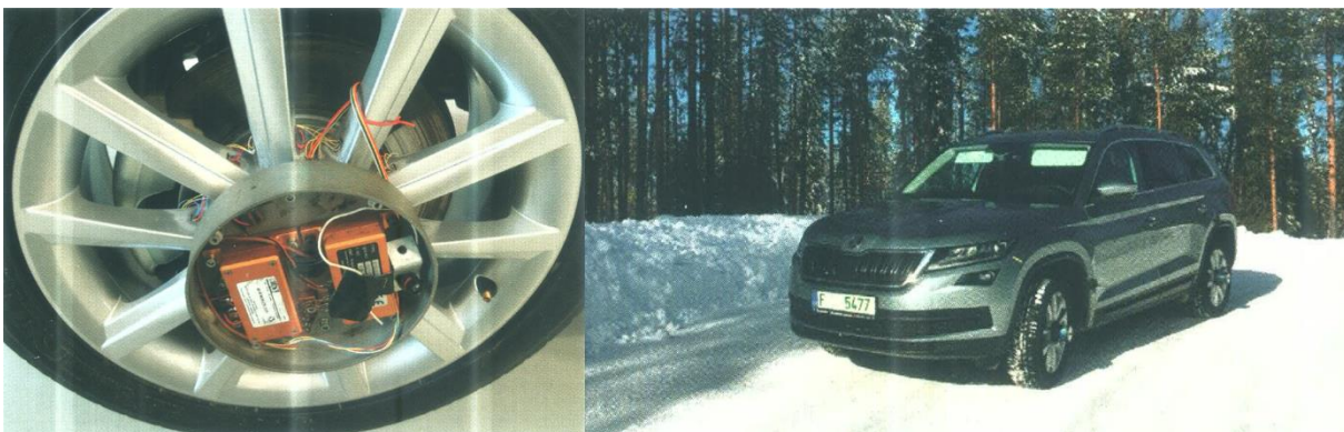
Obrázek 27 Telemetrický systém na Škoda Kodiaq [18]
