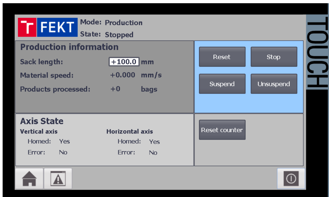
Obrázok 38: Obrazovka pre ovládanie baliaceho stroja v automatickom móde
