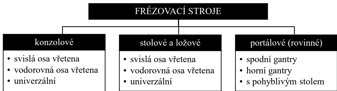
Obr. 2 Rozdělení frézovacích strojů [3]
