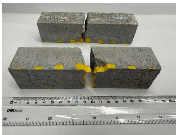
Obr. 9.3: Porušené vzorky s veľkosťou výstuže h = 10 mm
