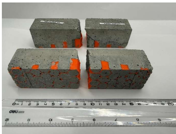
Obr. 9.5: Porušené vzorky s veľkosťou výstuže h = 20 mm
