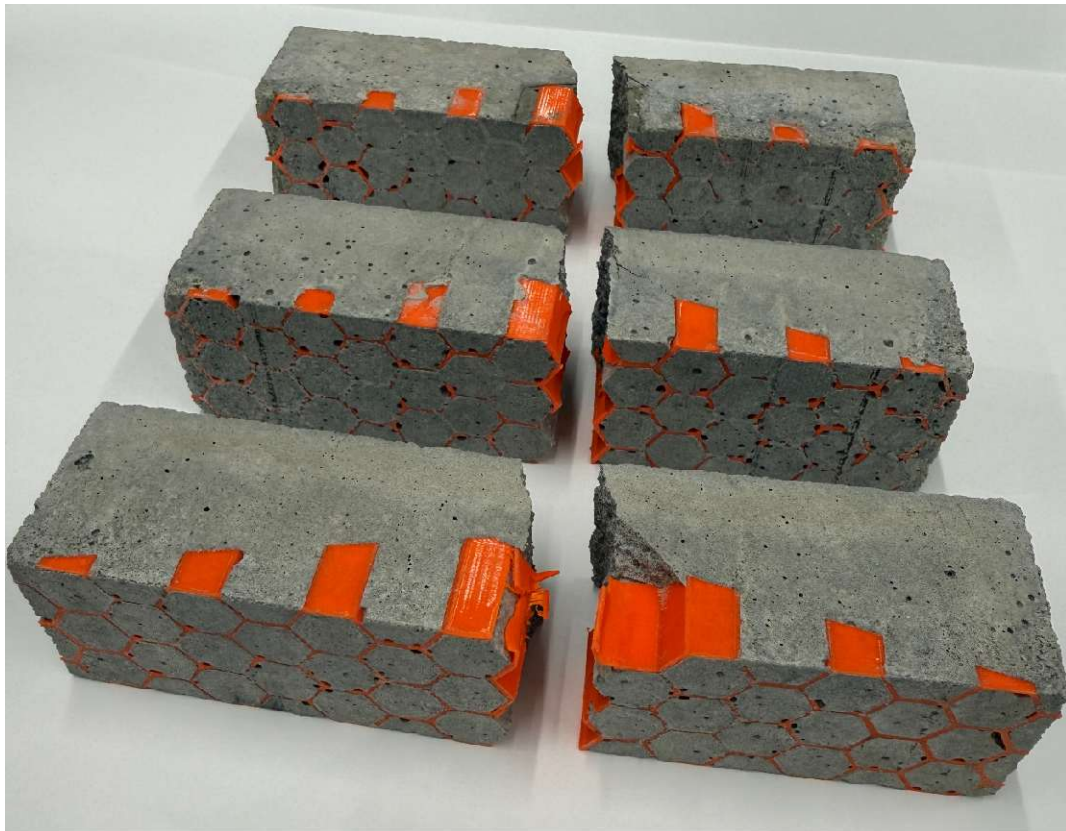
Obr. 9.6: Porušené vzorky s veľkosťou výstuže h = 20 \text{ mm} , porovnanie
