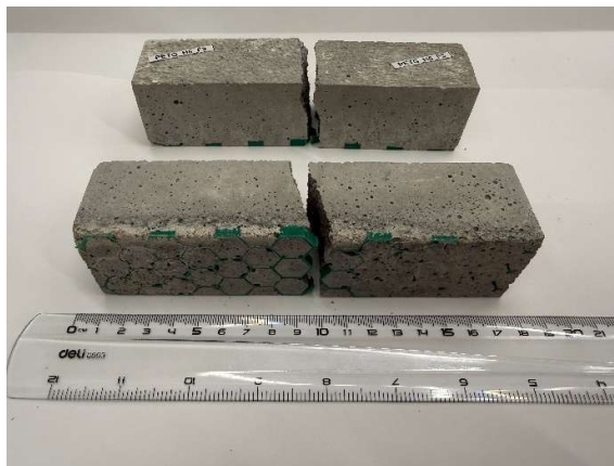
Obr. 9.2: Porušené vzorky s veľkosťou výstuže h = 5 mm
