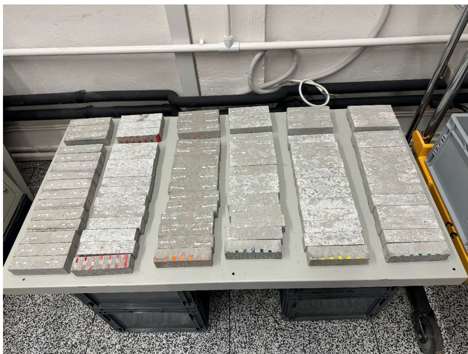
Obr. 8.3: Všetky experimentálne vzorky pred únavovou skúškou
