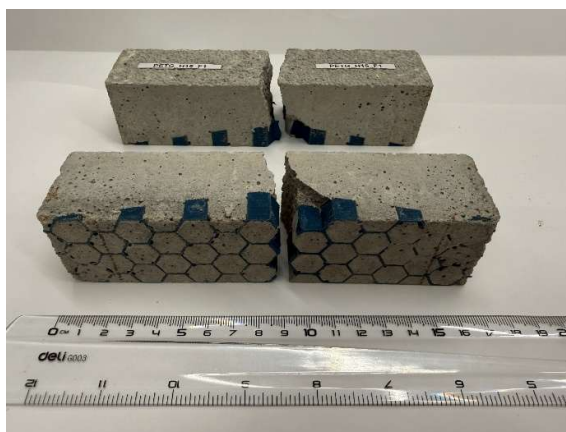
Obr. 9.4: Porušené vzorky s veľkosťou výstuže h = 15 mm
