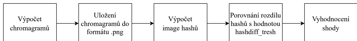
Obr. 6.11: Diagram algoritmu metody vyhodnocující shodu pomocí techniky Image Hashing
