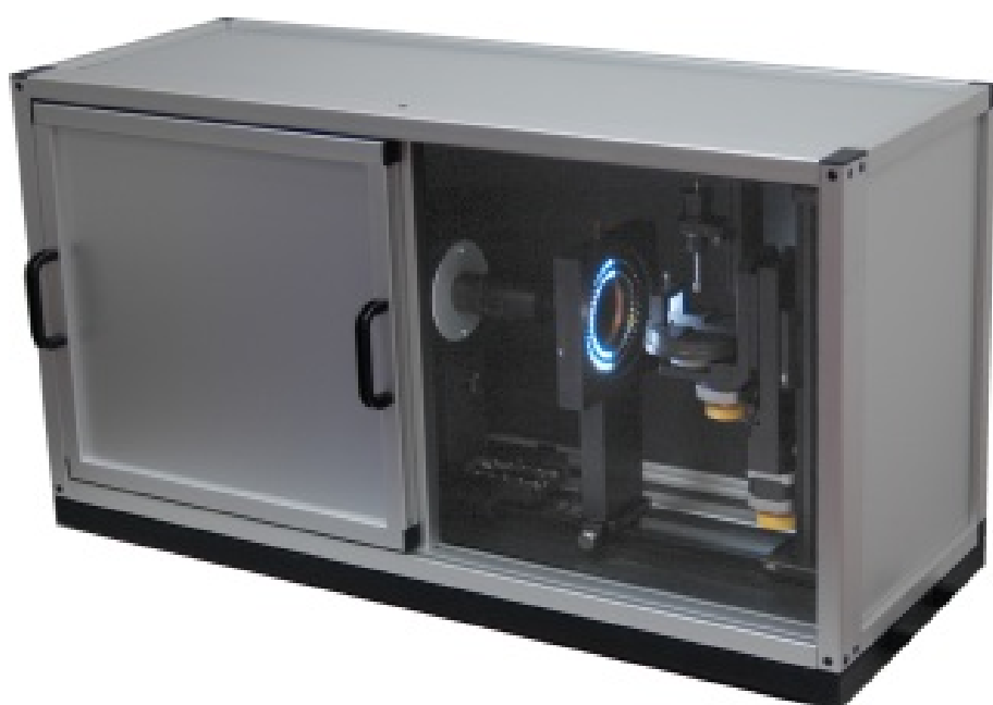
Obrázek 3.8: Systém obrazové analýzy Lucia BULLSCAN [2].
