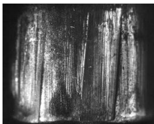
Obrázek 3.2: Rýhy na plášti střely jsou dynamickou stopou [3].
