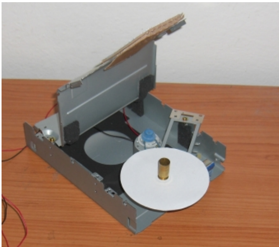
Obrázek 5.2: Otáčecí mechanismus s řemínkovým převodem.
