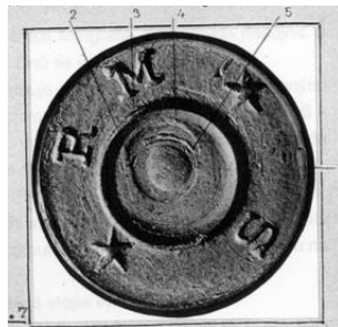
Obrázek 3.1: Otisk úderníku na dně nábojnice je statickou stopou [3].
