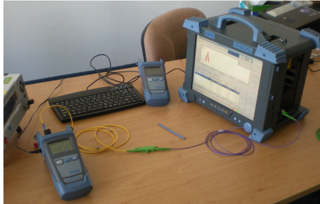
Obr. 7.6: Ukázka praktického zapojení referenčního měření
