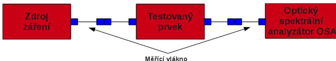
Obr. 7.3: Zapojení pracoviště pro měření součástky
