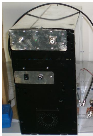
Obrázek 16: Pohled na kompletní zakrytovaný výkonový zesilovač
