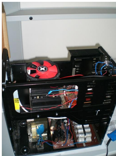
Obrázek 15: Výkonový zesilovač zabudovaný do boxu
