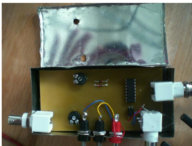
Obrázek 35: Realizace tvarovače signálu (operační zesilovače jsou ze spodní strany DPS)
