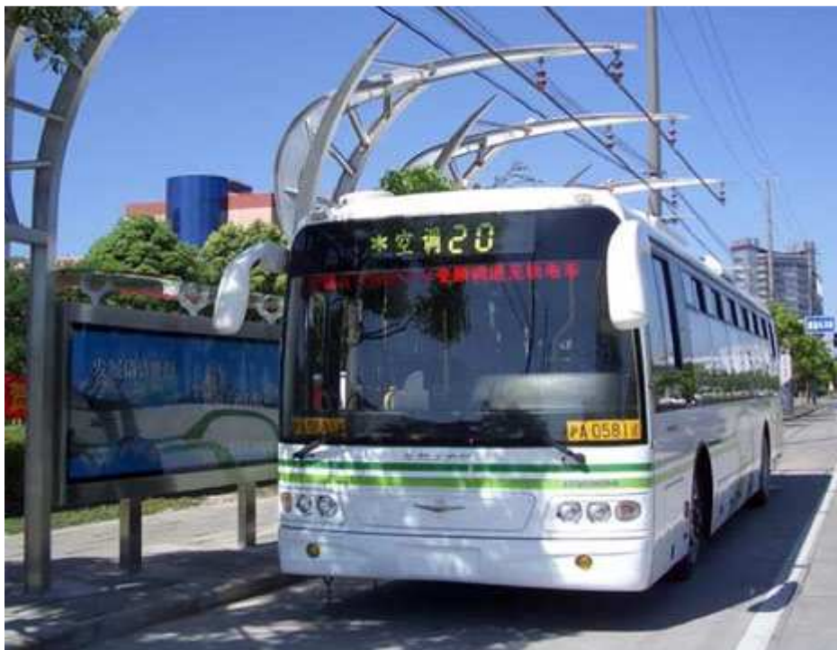
Obr.4.2 Sinautec Ultracap Bus se při dobíjení svých superkondenzátorů ve stanici zdrží pouze 2-3 minuty [32]
