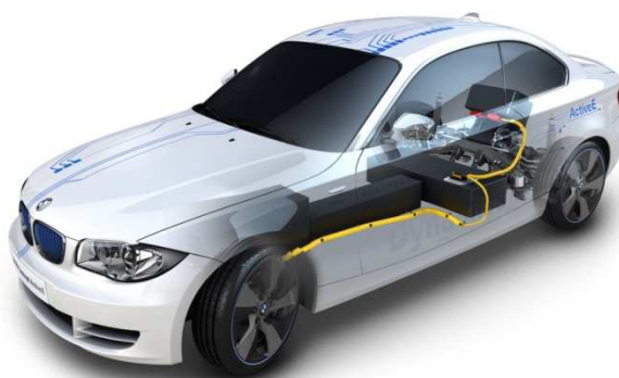
Obr.3.2 BMW ActiveE s elektromotorem vzadu [9]
