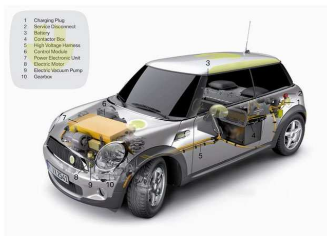
Obr.3.1 Mini E (kap.6.7) s elektromotorem vpředu [17]
