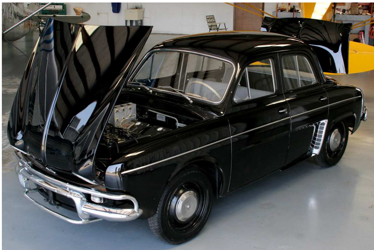
Obr.1.3 Henney Kilowatt, první elektromobil založený na tranzistorové technologii [21]
