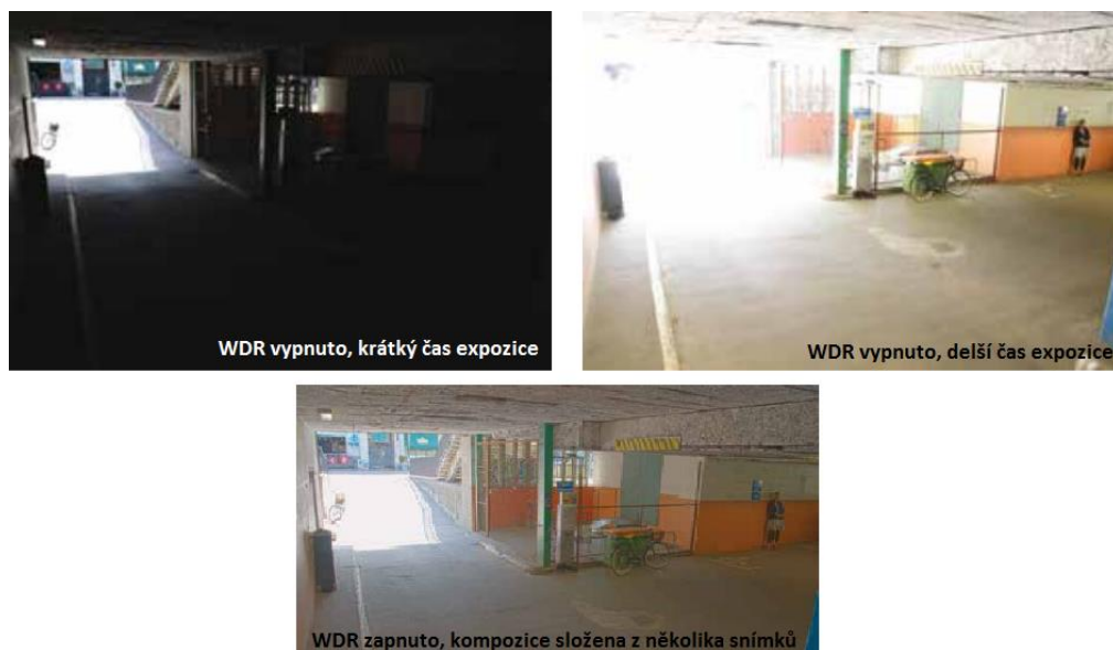
Obrázek 5.5 - Demonstrace efektu WDR Forensic Capture, převzato a upraveno[15]
