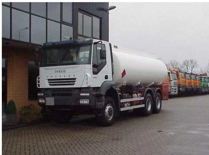
Obr. č. 11: Autocisterna značky IVECO o objeme 18 m 3
