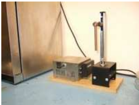
Obr. 54 Zařízení pro přípravu tenkých vrstev metodou dip-coating.
