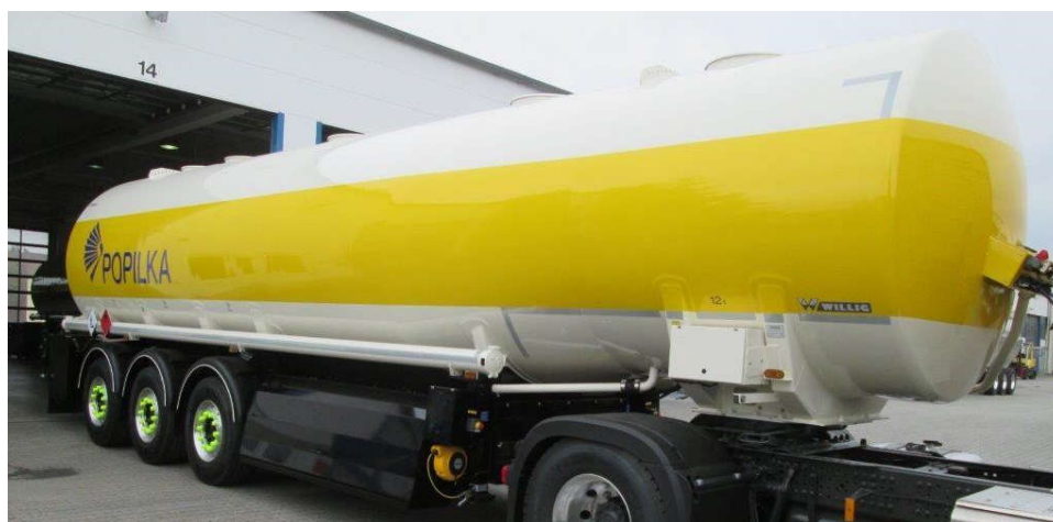
Obr. 28 WILLIG: třínápravový hliníkový cisternový návěs [8]
