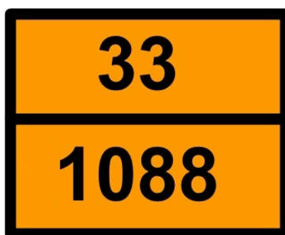
Obr. 3 Příklad oranžové identifikační tabulky [4]
