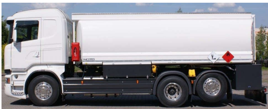
Obr. 18 Cisternová nástavba firmy WILLIG [8]
