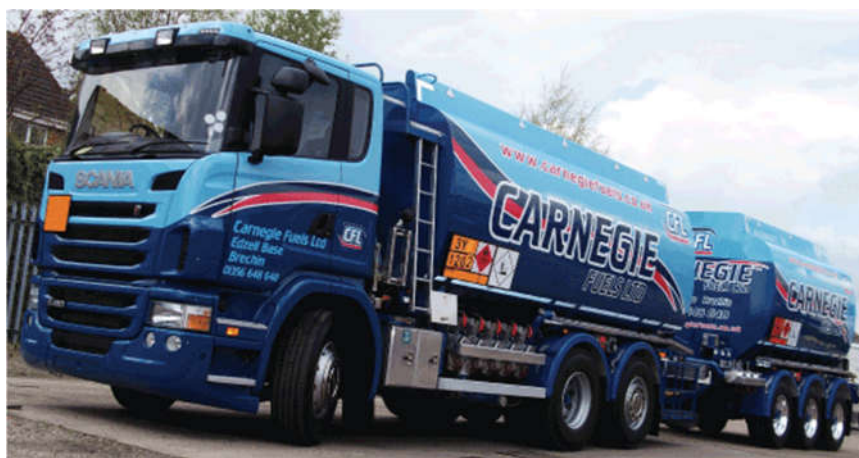
Obr. 27 TASCA Tankers: cisternová nástavba s přívěsem [12]
