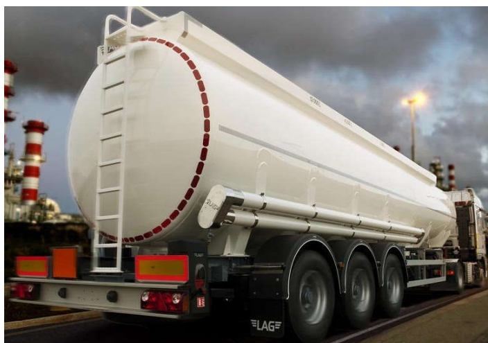
Obr. 25 LAG: třínápravový hliníkový cisternový návěs [10]
