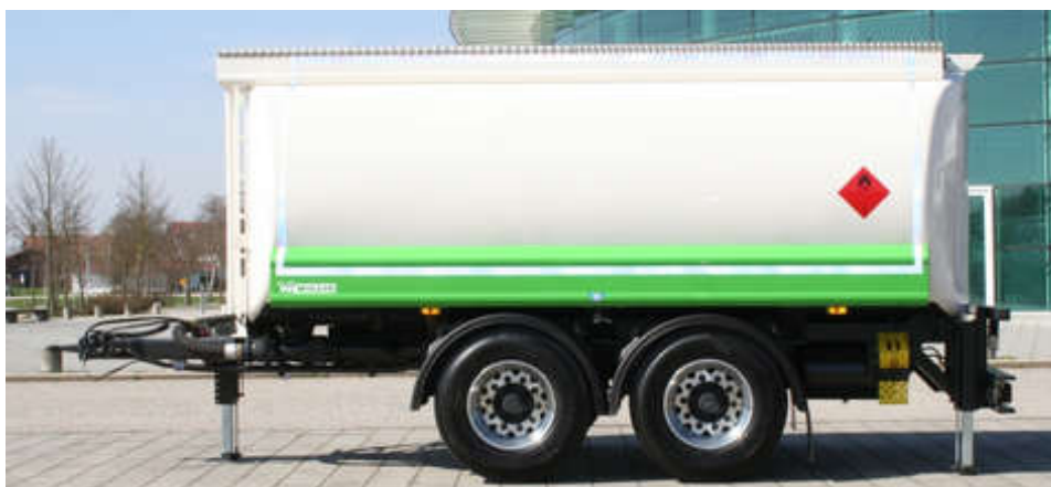
Obr. 30 Willig: jednokomorový cisternový přívěs s nápravami uprostřed [16]
