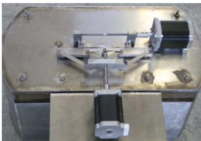
12 Krokové motory stávajícího kolimátoru
